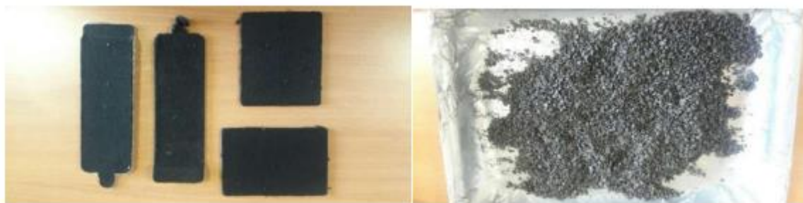
Рисунок 1. Отходы листового полипропилена: исходные (слева) и после отделения полиэфирной ткани и измельчения (справа)
